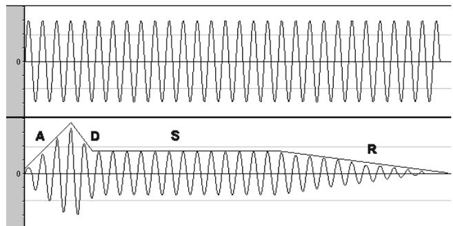
Figura 6 - Envolvente aplicado a uma onda.
